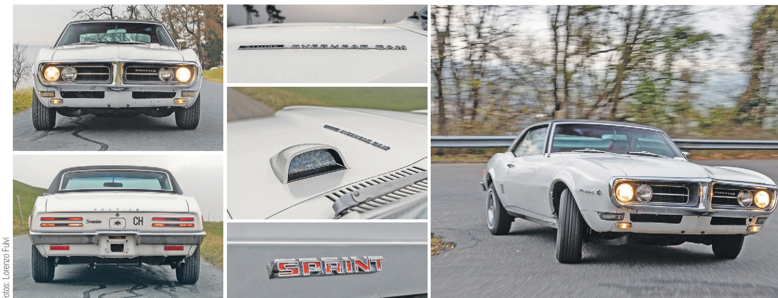
Aggressiv Bezeichnend ist die breite Spurweite (Wide Track). Embleme an der Unterseite der vorderen Kotflügel und auf der Motorhaube kennzeichnen die Sprint-Version. Der Drehzahlmesser wurde auf die Motorhaube verbannt.
